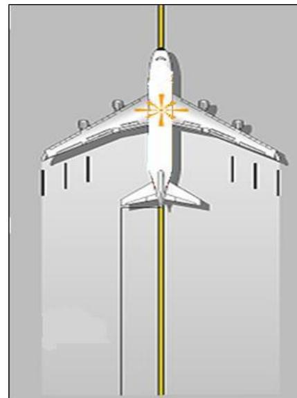
**Figura A1-6. Distancia de precaución cuando la aeronave está en movimiento (Aeronaves convencionales 75m - Fuselaje ancho 125m)**
